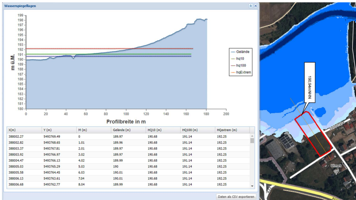
Längsschnitt durch das Flurstück 469/1 mit Wasserspiegellagen HQ 10 , HQ 100 und HQ Extrem
